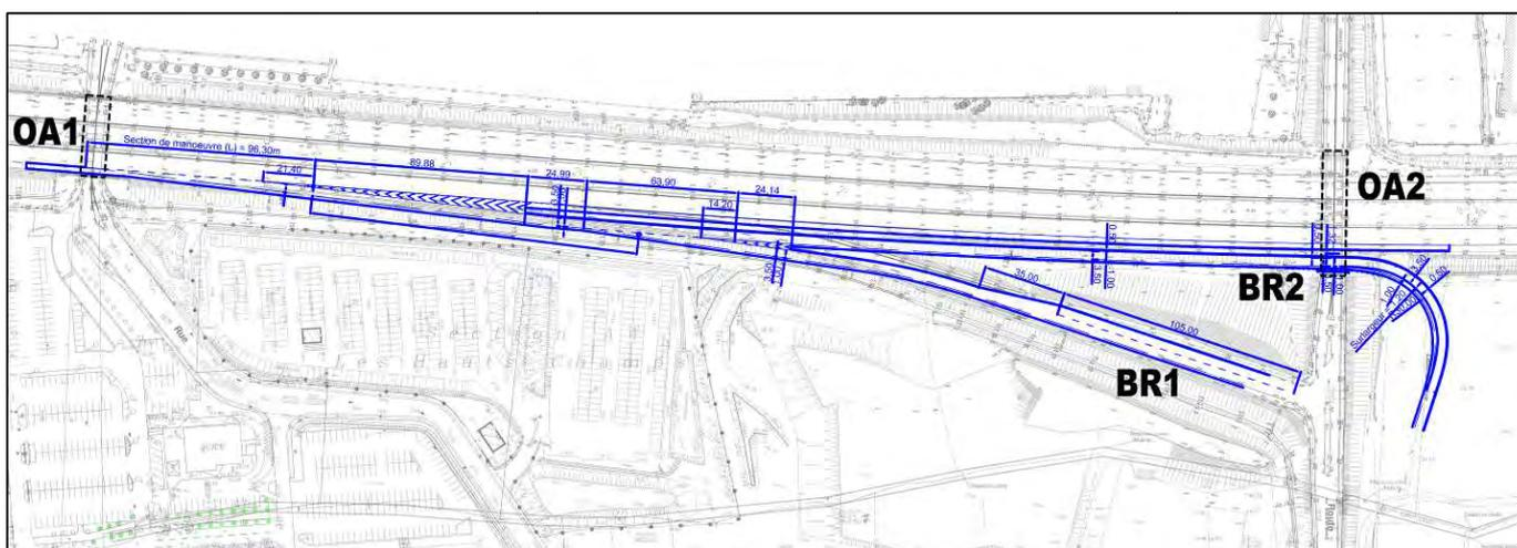
La géométrie proposée prévoit la création d'une nouvelle bretelle de sortie (*BR1*) assurant une liaison directe vers les nouvelles installations commerciales de l'ilot Promenade de Flandres, la bretelle de sortie existante (*BR2*) est conservé et s'implante en ramification de sortie sur la nouvelle bretelle.
